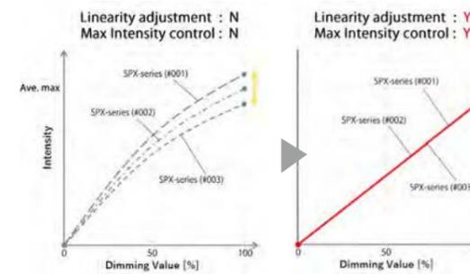
장비간 편차를 줄이는 밝기 선형성(Linearity) 및 제품 최대 밝기(Max intensity control) 보장
